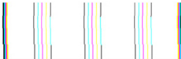
Рисунок 12 – Дефект печати на шаблоне выравнивания
